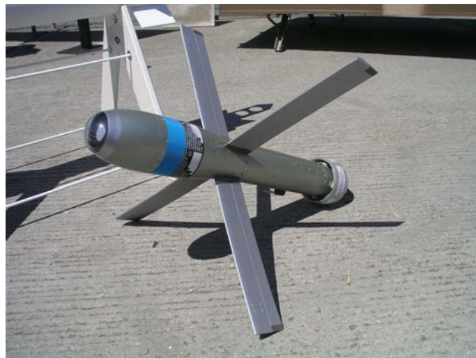
그림 VIII-24. GBU-44 Viper Strike가 발사된 후 날개를 전개한 상태의 모습
