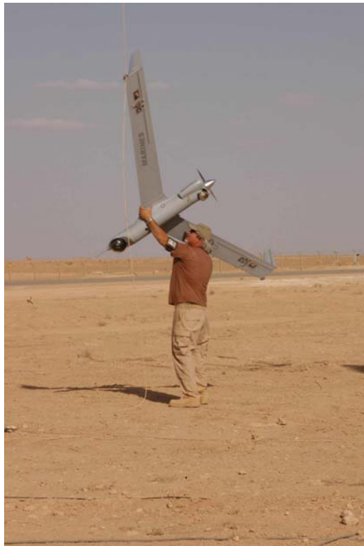
그림 VIII-61. SkyHook 회수 시스템을 이용한 ScanEagle의 회수
