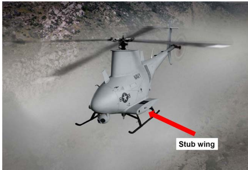
그림 VIII-93. MQ-8B에는 Stub wing이 설치되어 있다.
