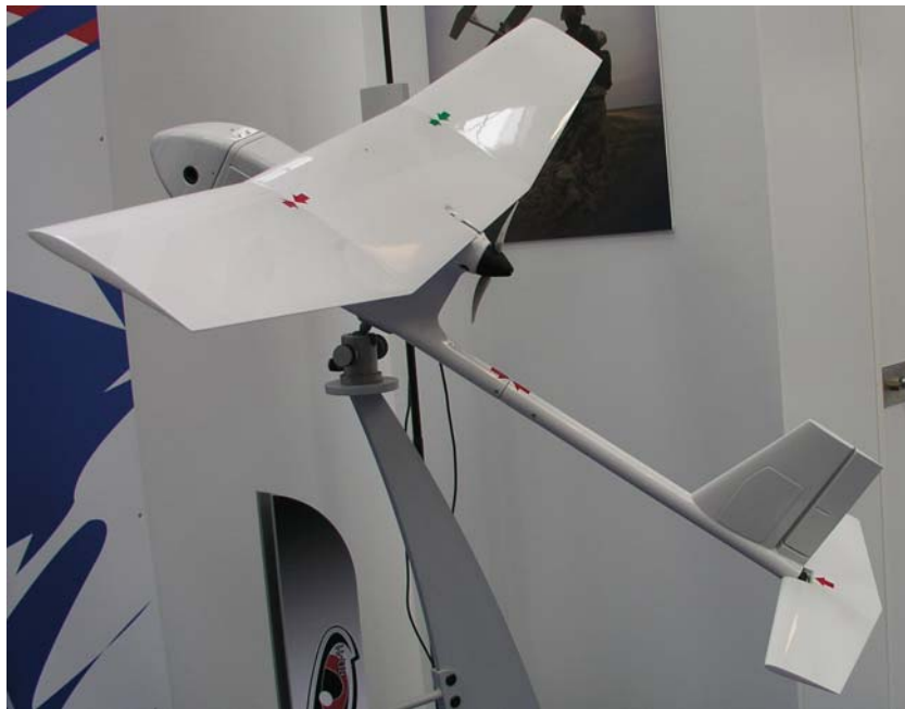
그림 VIII-69. Raven은 동체후방에 배치된 Pusher type propeller를 사용한다.
