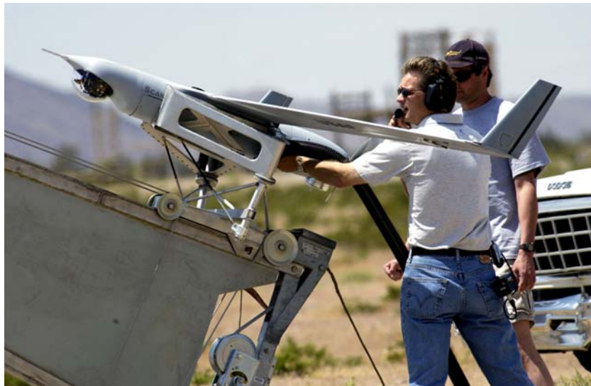
그림 VIII-59. Insitu社의 SuperWedge 사출기에 설치된 ScanEagle
