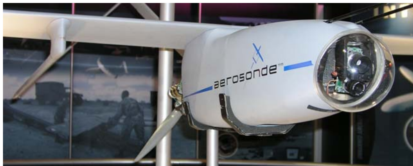
그림 VIII-73. Insitu Aerosonde의 정면-전방동체에 새롭게 설치된 관측창이 보인다.
