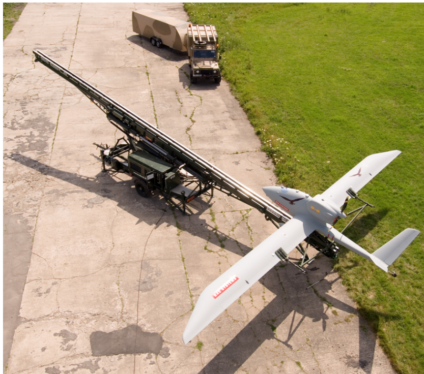
그림 VIII-25. Robonic社의 MC255LLR 사출기에 설치된 HERTI
