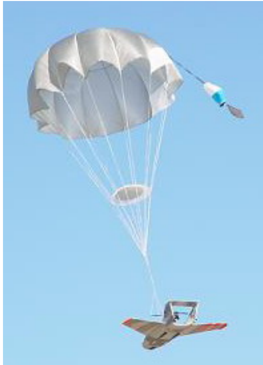
그림 VIII-55. 낙하산을 이용한 기체회수
