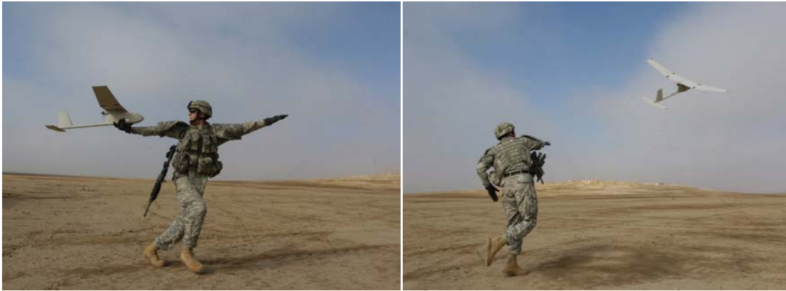
그림 VIII-70. 손으로 던져서 이륙시키는 RQ-11 Raven
