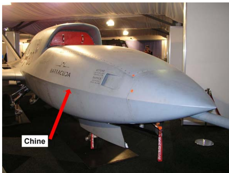
그림 VIII-6. 전방동체의 형식은 스텔스 항공기에 흔히 보이는 chine형 전방동체이다.
