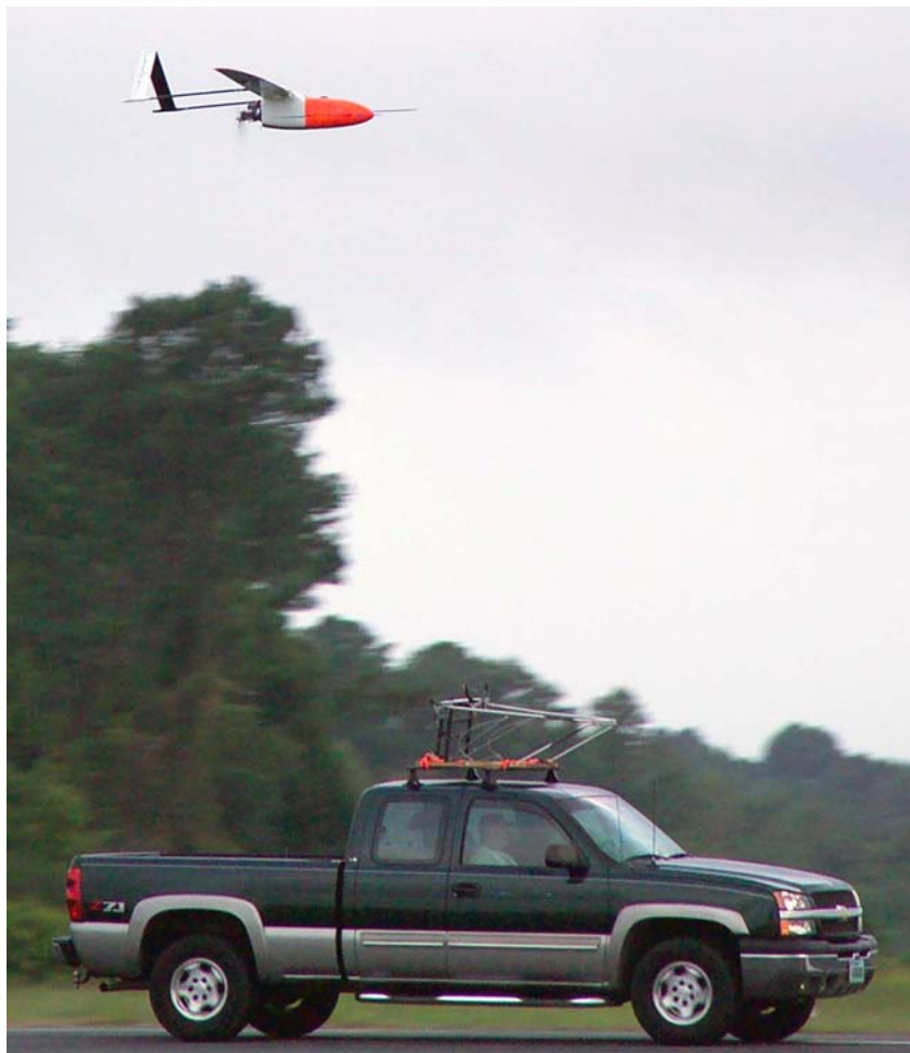
그림 VIII-78. 차량을 이용해서 이륙하는 Aerosonde
