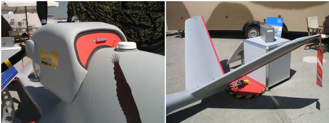
그림 VIII-21. HERTI의 공기흡입구와 V-tail 형식의 꼬리날개
