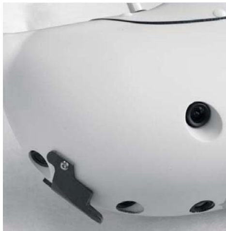
그림 VIII-47. 페이로드 포드의 전방에 설치된 4개의 주간 비디오 카메라
