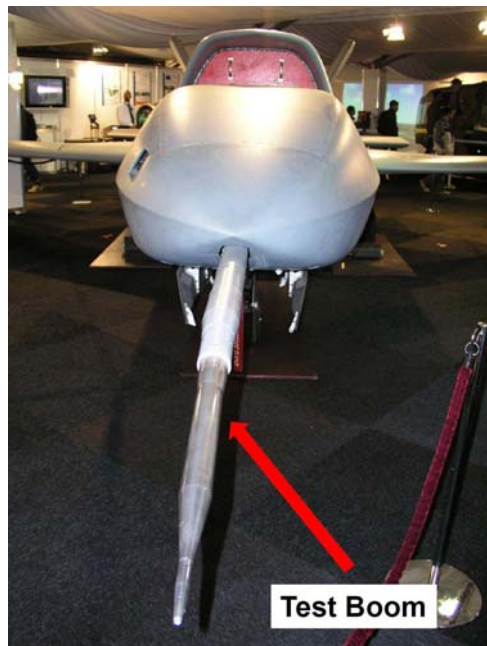
그림 VIII-9. 비행시험중 대기자료를 측정하는 Test Boom
