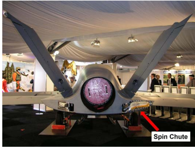
그림 VIII-7. 후방동체의 노즐 측면에는 Spin chute가 설치되어 있다.
