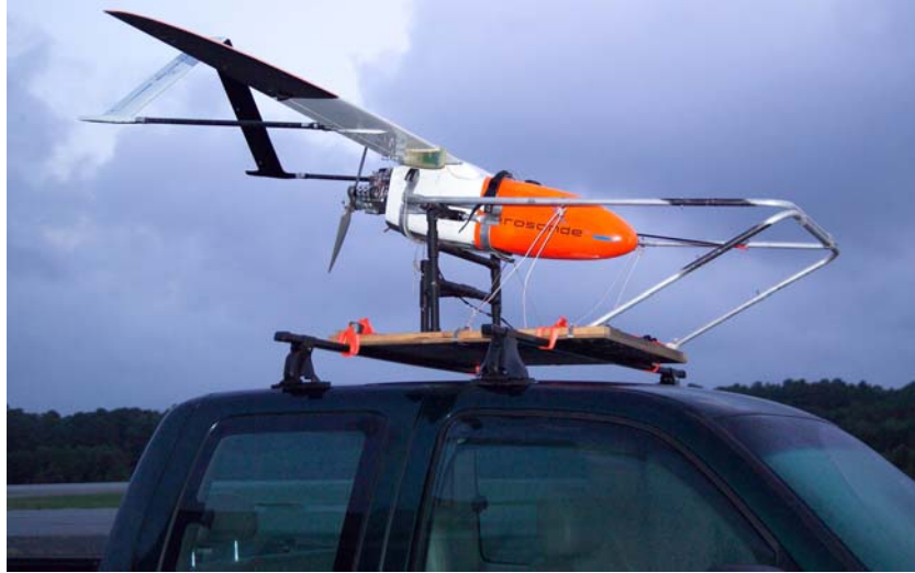
그림 VIII-77. 이륙을 위해 차량상부에 설치된 Aerosonde
