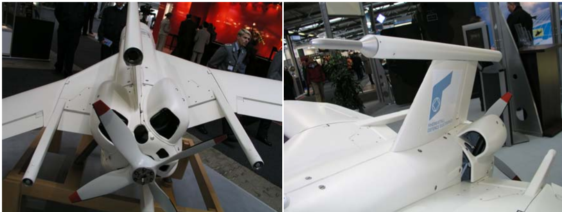
그림 VIII-38. Rheinmetall TARES 공격드론의 프로펠러와 대기자료 측정관
