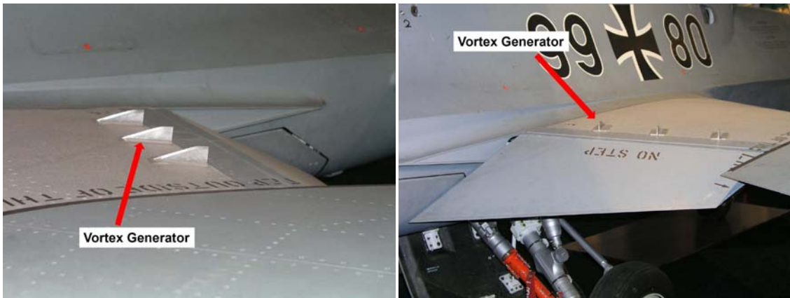
그림 VIII-8. Flaperon 전방에는 3개의 Vortex Generator가 설치되었다.
