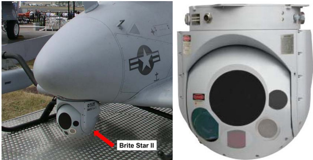
그림 VIII-88. 전방동체 하단에 설치된 BRITE Star II 회전식 센서 탑재부
