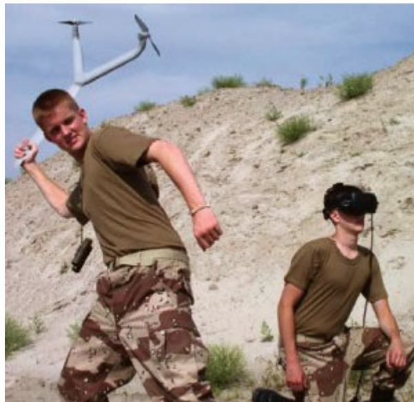
그림 VIII-109. 무메랑처럼 던져서 이륙시키는 Phantom Sentinel
